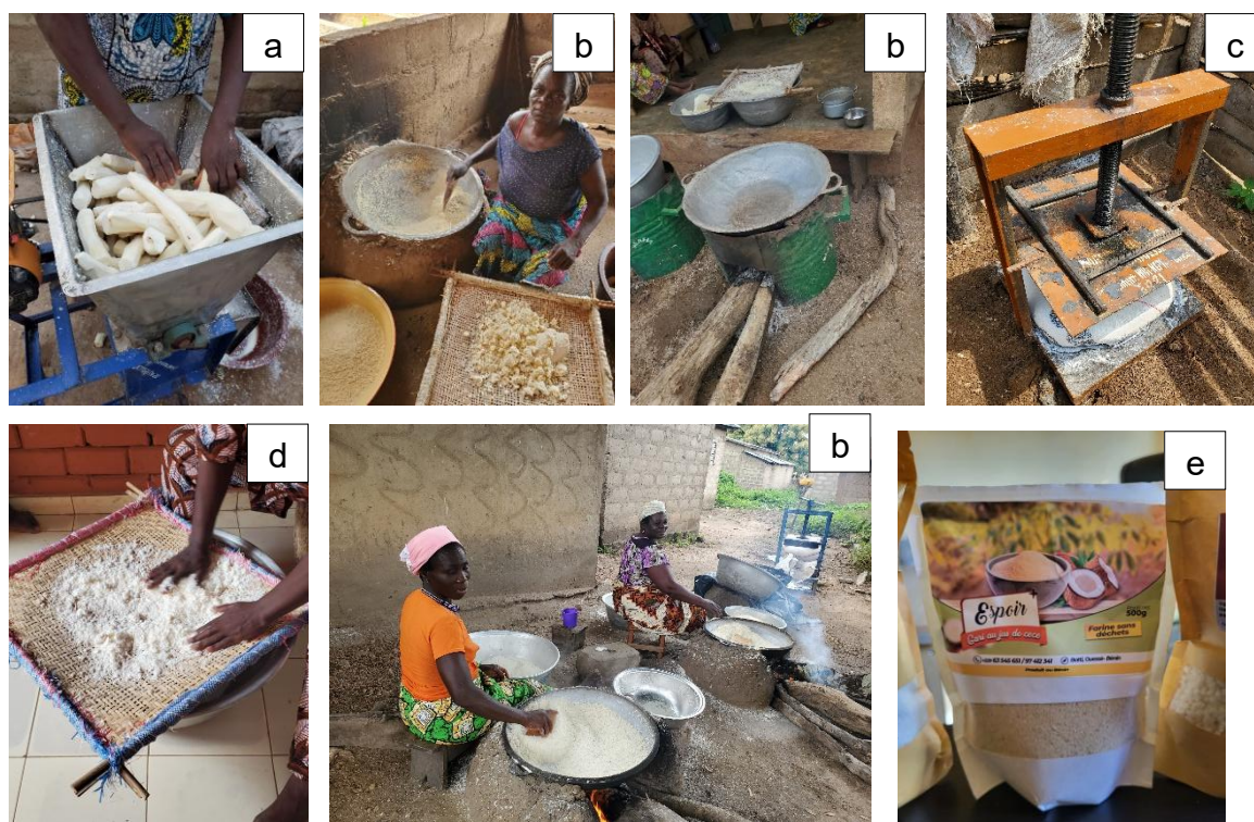
Figure 33 : Matériel de transformation au Bénin, Ouèssè. (a) Râpeuse électrique. (b) Foyers améliorés. (c) Presse manuelle pour la fermentation. (d) Tamis pour obtenir une granulométrie fine. (e) Gari conditionné. (Auteure, 2022)
